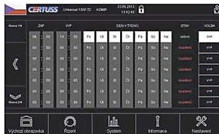
Ukázka zobrazení pro volbu dní pro právě nastavený režim provozu s nastaveným zapínacím a vypínacím časem provozu parního vyvíječe.
