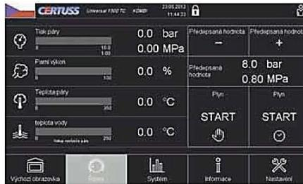
Menu Thermotimat umožňuje libovolný vstup do naprogramovaného nastavení a provést ruční spuštění nebo vypnutí vyvíječe mimo nastavené časy.
